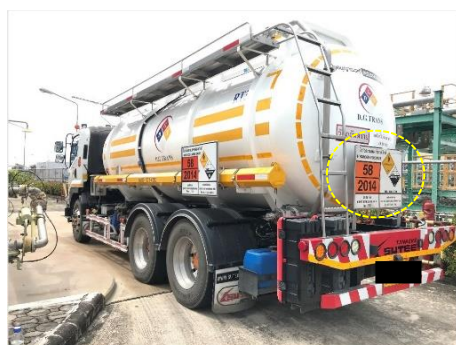
ภาพที่ 2.2-13 ป้ายแสดงความเป็นอันตรายที่ติดรถบรรทุกสารเคมี
